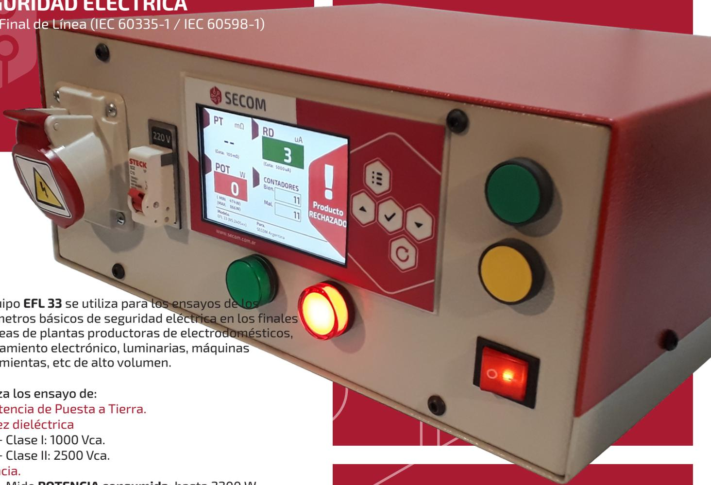
El equipo **EFL 33** se utiliza para los ensayos de los parámetros básicos de seguridad eléctrica en los finales de líneas de plantas productoras de electrodomésticos, equipamiento electrónico, luminarias, máquinas herramientas, etc de alto volumen.
