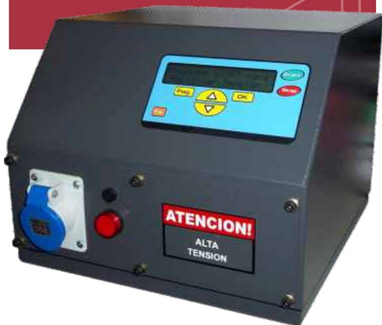
Equipo diseñado para realizar ensayos de Rigidez Dieléctrica a termocontraibles, según la norma IEC 60454-2 (IEC 60243-1)
